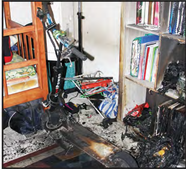
Sebuah skuter elektrik yang terbakar di dalam bilik tidur pada bulan Nov 2017, menyebabkan empat orang menjadi mangsa.
